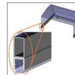
Das neue Befestigungssystem für die Haube sieht keine Glashalteleisten mehr vor. Die Befestigung erfolgt direkt.
