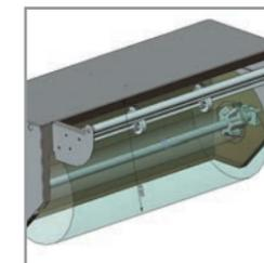
Die Rollenhalterung wurde vergrößert, um Folienrollen mit einem Durchmesser bis zu 250 mm aufnehmen zu können: nützlich für die Verwendung von mikroperforierter Folie für die Brotverpackung.
